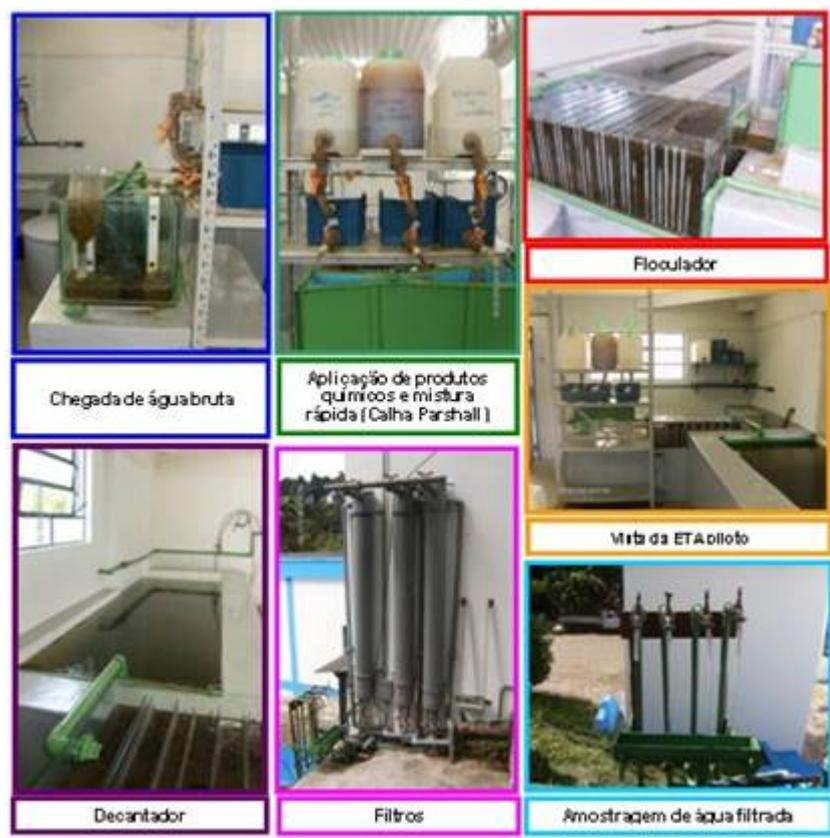
**Figura 1: ETA piloto utilizada no estudo.**
